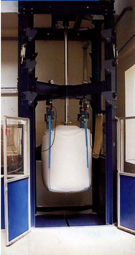
Стенд для испытаний контейнеров Labordata UVP 300
